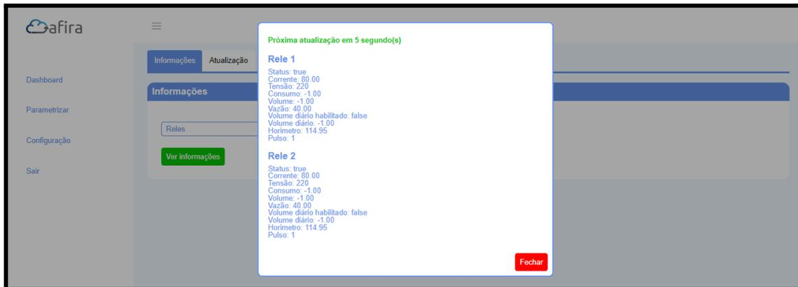
1.1.2 - VISUALIZAR ENTRADAS DIGITAIS: Ao clicar no botão **Ver Informações** será aberto uma caixa com o último dado coletado do local da instalação relação às entradas digitais (sensores de pulso);
